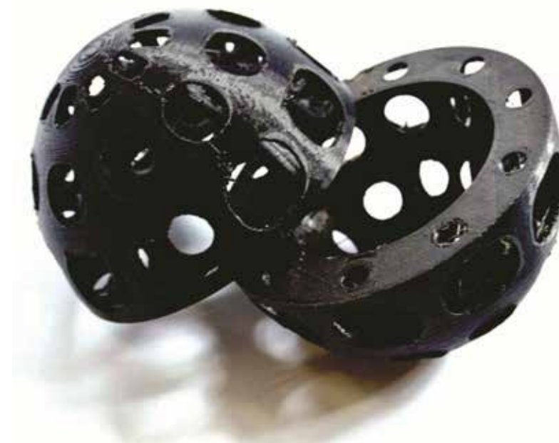
Figura 15 – Protótipo do conceito de design (a) executado na Makerbot com filamento NinjaFlex
