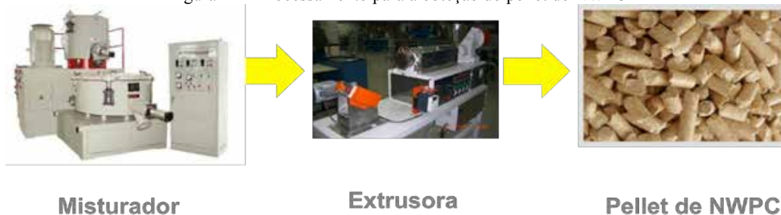
Figura 12 – Processamento para a obtenção do pellet de NWPC
