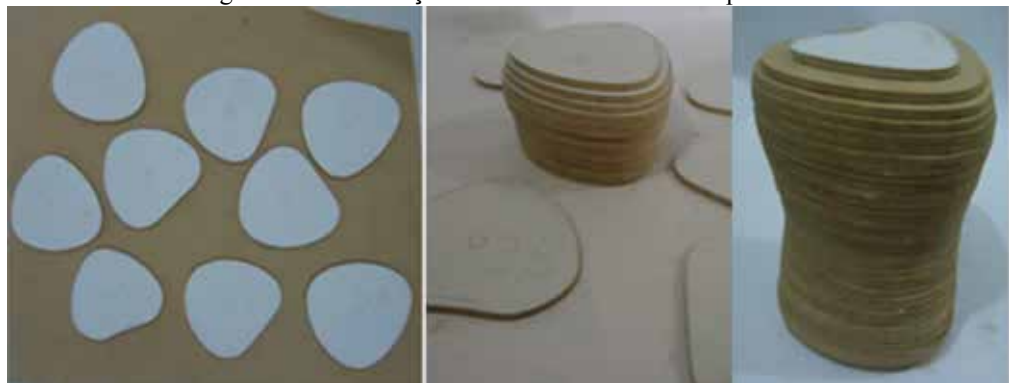
Figura 07 – Construção do modelo em Placas empilhadas.
