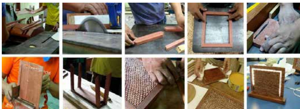
Figura 4 – Processo de confecção do protótipo TIBA (luminária de cabeceira de cama)
