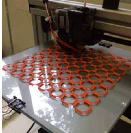
Figura 18 – Impressão 3D do conceito (b) na impressora Felix com NinjaFlex .
