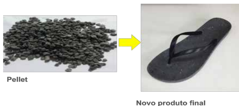
Figura 18 – Novo produto obtido através do processo de injeção
