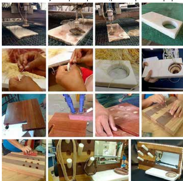
Figura 5 – Processo de confecção do protótipo NIU (painel/expositor de pequenos acessórios)
