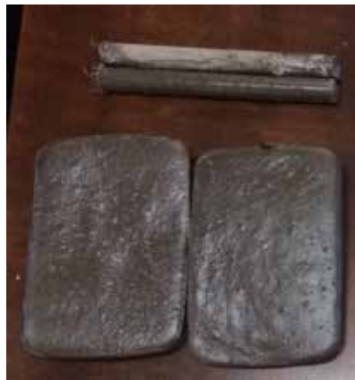
Figura 5 – Corpos de prova (aglutinante Kehl)
