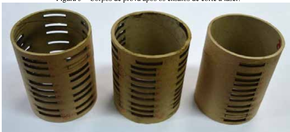
Figura 5 – Corpos de prova após os ensaios de corte a laser.
