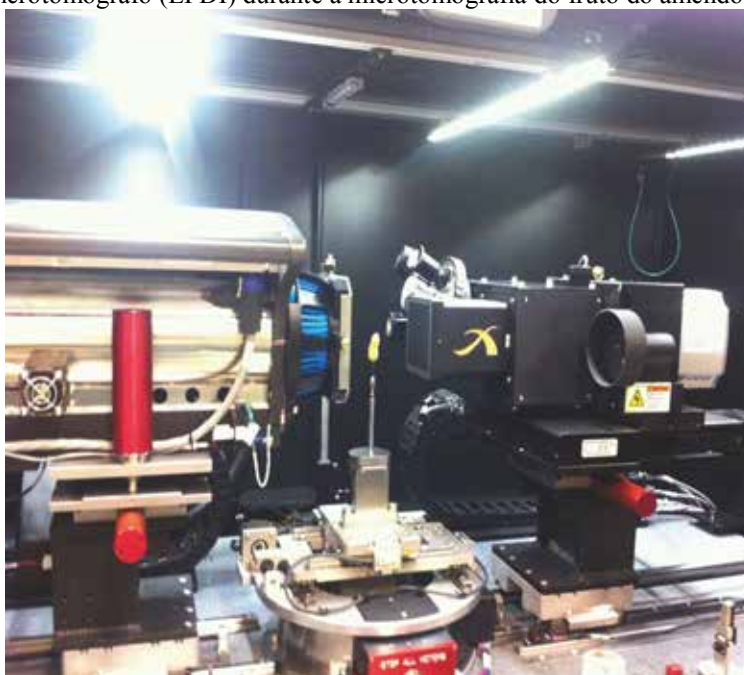
Figura 6 – Microtomógrafo (LPDI) durante a microtomografia do fruto do amendoim
