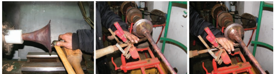
Figura 6 Da esquerda para direita: Repuxagem da com martelo no torno. Repuxagem da peça no torno com goiva. Fonte Ermanno Aparo, 2016.
