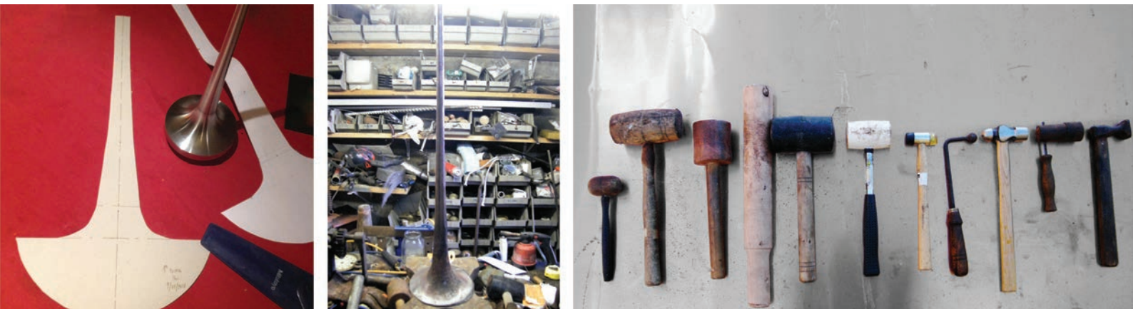
Figura 3 Da esquerda para direita: Molde em aço e 2 planificações da campana. Cópia do molde em chumbo. Malhos e martelos utilizados no processo
