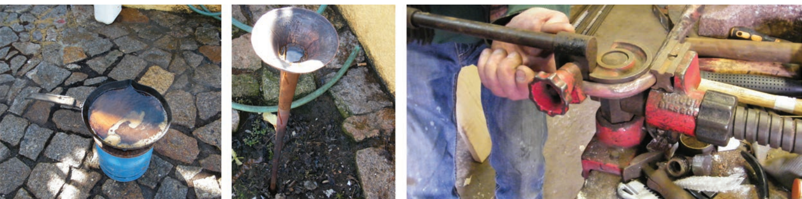
Figura 7 Da esquerda para direita: Preparação da mistura de colofônia e parafina. Mistura de colofônia e parafina vertida na peça. Processo de dobragem.
