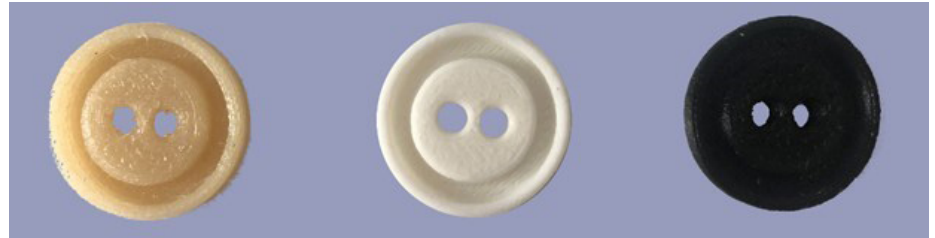
Figura 5 Teste dos botões em material TPU, ABS e PETG
