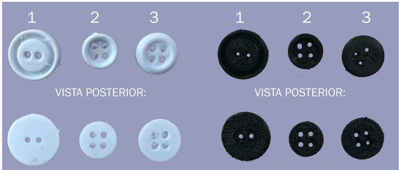
Figura 4 Teste botões de furos na impressora Cliever
