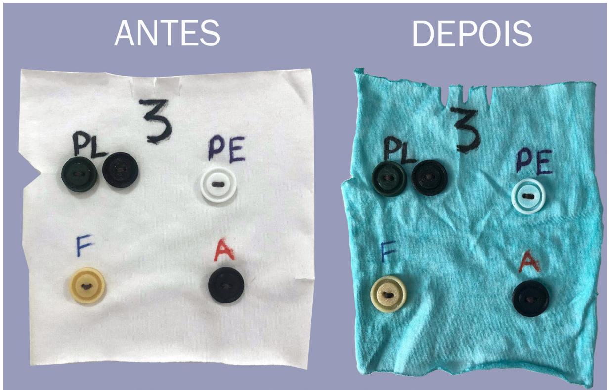
Figura 8 Teste dos botões no tingimento a seco
