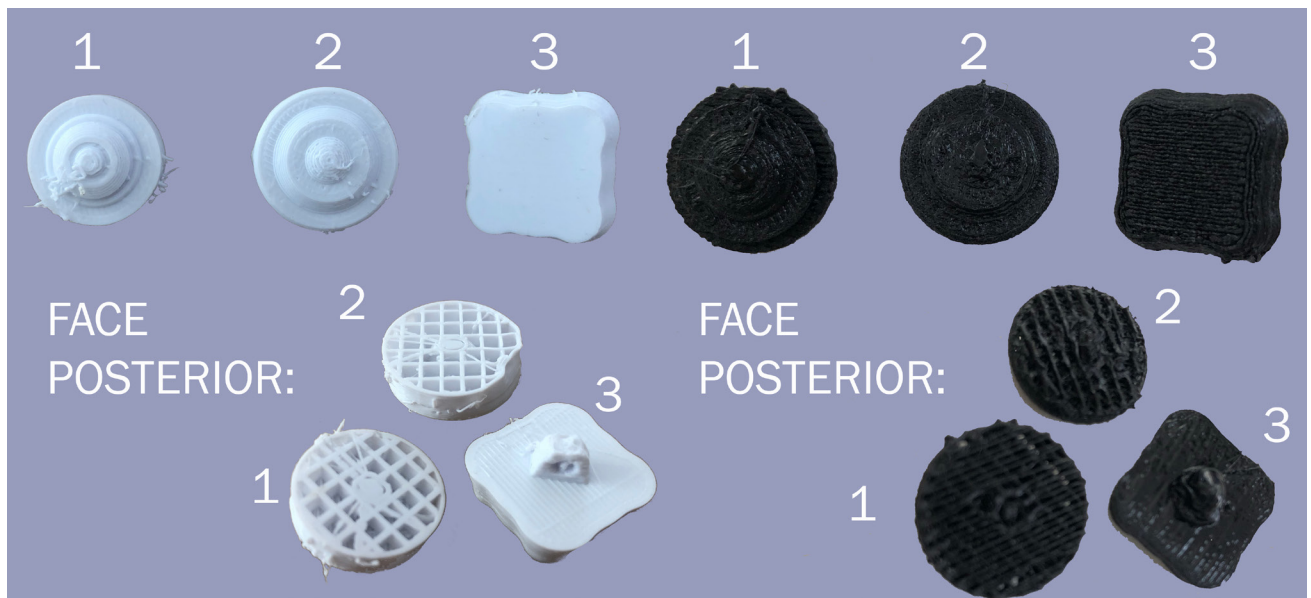
Figura 3 Teste botões com pé na impressora Delta (esquerda) e Cliever (direita)
