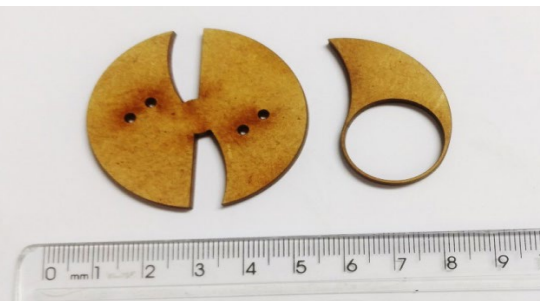
Fig 16. Obtenção dos Mockups em MFD para os testes de usabilidade e interação com os usuários. Fonte: Autor, 2020
