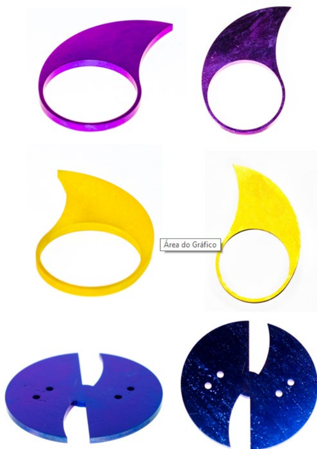
Fig 31. Resultado do processo eletroquímico (Anodização) em diferentes cores (tons) nas joias em Nióbio Fonte: Autor (2020)
