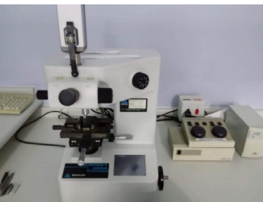
Fig 6. Microdurômetro utilizado para os ensaios de Microdureza Fonte: autor (2020)
