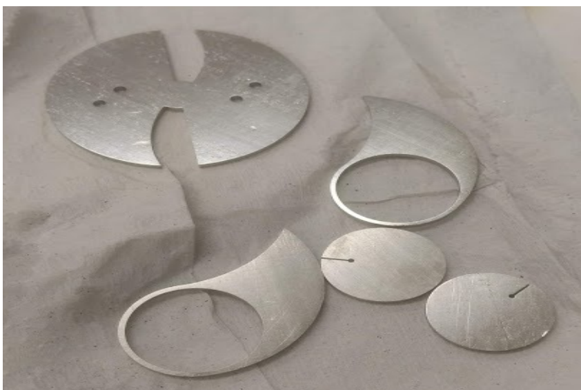
Fig 29. Peças após decapagem química sem resíduos em sua superfície com marcas na superfície diante do processo de deformação (laminação) Fonte: Autor (2020)
